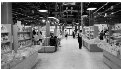
天井を外し吹き抜けにすることで圧迫感をなくした
